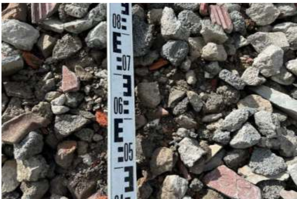
Foto 2: Detailaufnahme der recycelten Gesteinskörnung
